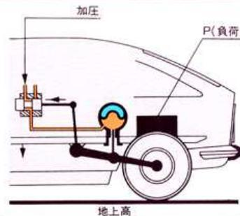
**3** 車体に負荷Pがかかるると車体は下り、アームのリンクエッジが矢印の方向に動いてハイトコレクターのスライドバルブを開け油圧がサスペンションシリンダー内に流入し車高を復元します。
