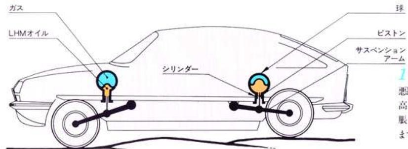
1 悪路上での状態で前輪は車高を上げるためガス室が膨脹し、後輪は圧縮されています。
