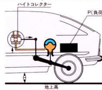
**4** 車高が復元されるとハイトコレクターのリンクエッジは正常の位置にバルブを戻しサスペンションシリンダーの油圧の回路を閉じます。
