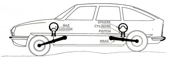
Dans le cas d'un « trou » le gaz se détend, le liquide de la sphère passe dans le cylindre, en traversant toujours l'amortisseur.
